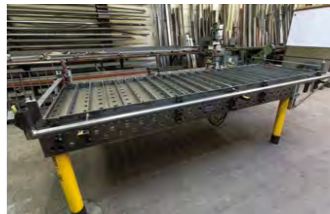
Auf speziellen Schweißtischen werden die Werkstücke passgenau fixiert und fest verbunden.
